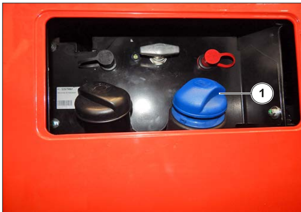
Figure 122: Remplissage du réservoir de DEF
