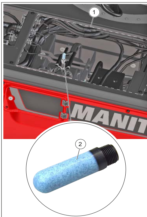
Figure 205: Remplacement du reniflard du réservoir de « DEF »
